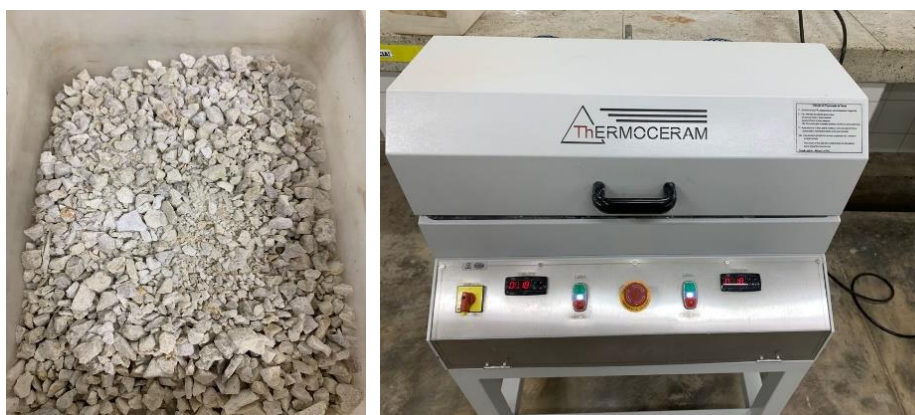
Figura 2: Feldspato albíta antes da moagem. Figura 3: Moinho de jarros Thermoceram.
