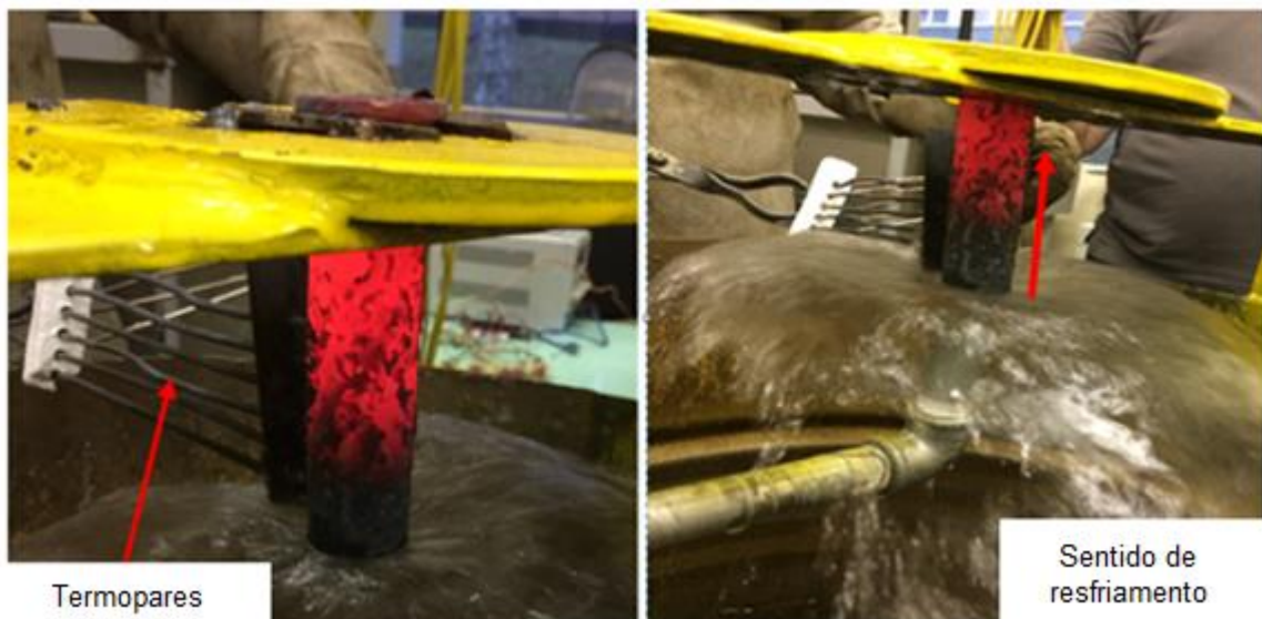
Figura 10 - Procedimento de temperabilidade, Ensaio Jominy, onde a) Termopares instalados no corpo de prova e b) sentido de resfriamento do corpo de prova
