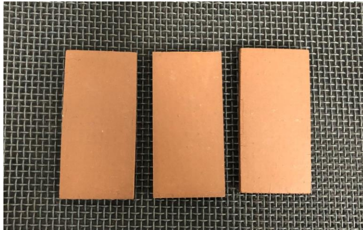
Figura 4: Corpos de provas queimados.
