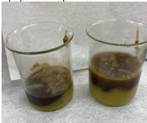
Figura 3: Separação de fases entre óleo e polpa na extração mecânica.
