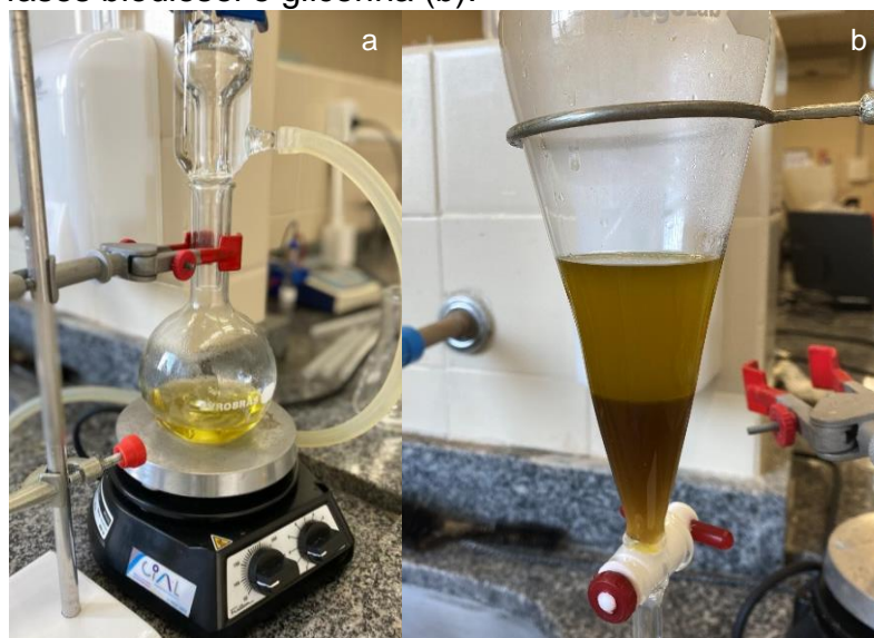
Figura 4: Produção de biodiesel (a) e separação de fases biodiesel e glicerina (b).
