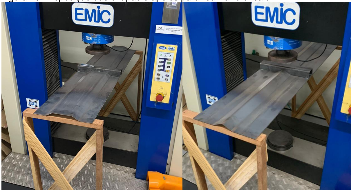
Figura 18: Disposição das chapas e apoios para realizar o ensaio.
