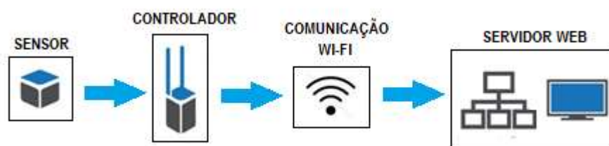
Figura 7: Exemplificação da estrutura funcional do sistema proposto.
