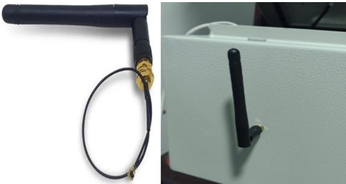
Figura 19: Representação da montagem da antena.
