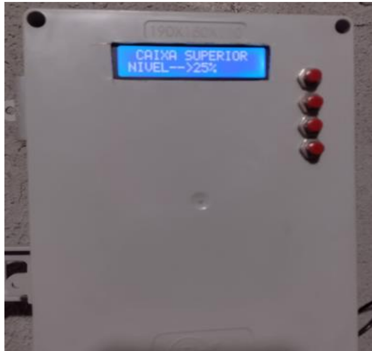
Figura 10: Display LCD com indicação do nível atual.
