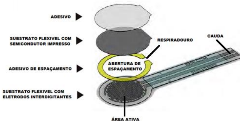
Figura 5: Vista explodida do sensor resistivo de força
