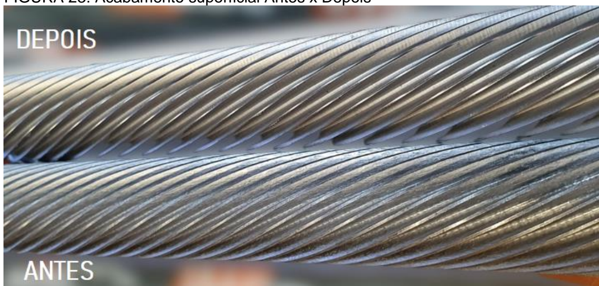
FIGURA 23: Acabamento superficial Antes x Depois
