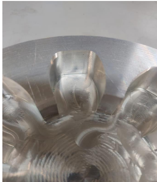
Figura 14: Acabamento com o método Wave Form.
