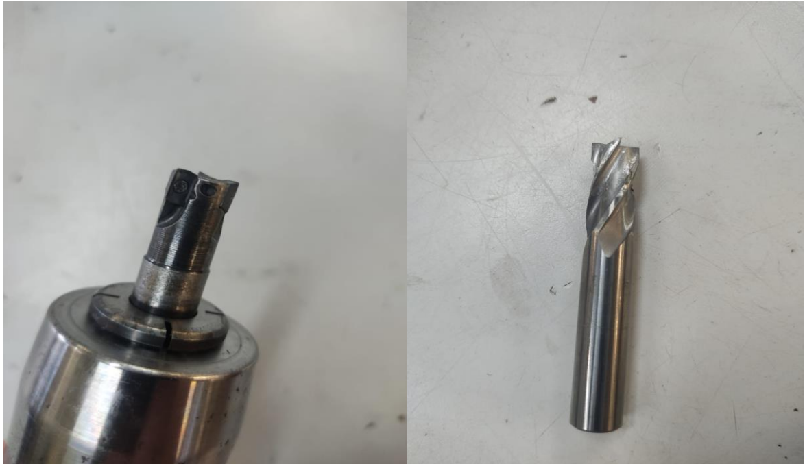
Figura 10: Fresa intercambiável, lado esquerdo. Fresa inteiriça, lado direito.
