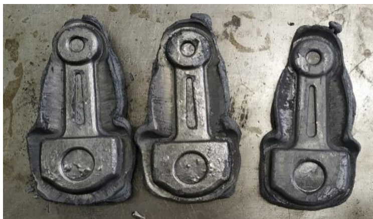
Figura 12: Forjamento de bielas pelo processo de manufatura aditiva
