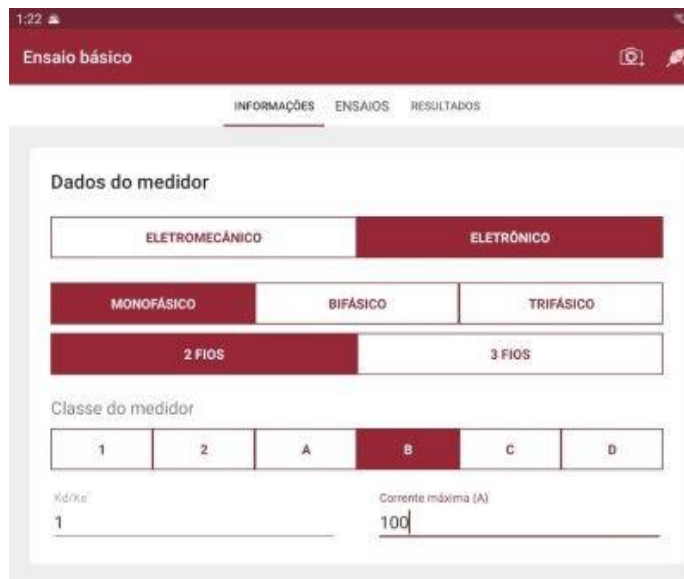
Figura 3 – Informações do Ensaio básico dos medidores de energia elétrica.
