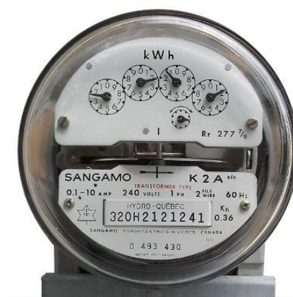
Figura 1 – Medidor Eletromecânico de Energia
