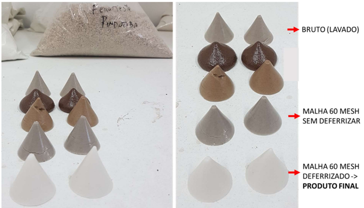
Figura 18 – Cones de fusão referentes ao feldspato estudado e seus produtos.
