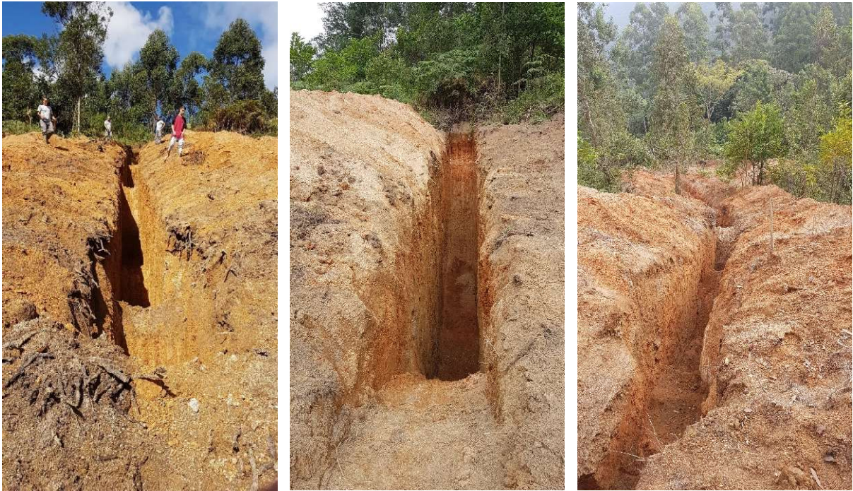
Figura 8 – Trancheiras mecanizadas, realizadas com grande extensão e profundidade, para melhor exposição do minério em subsuperfície.
