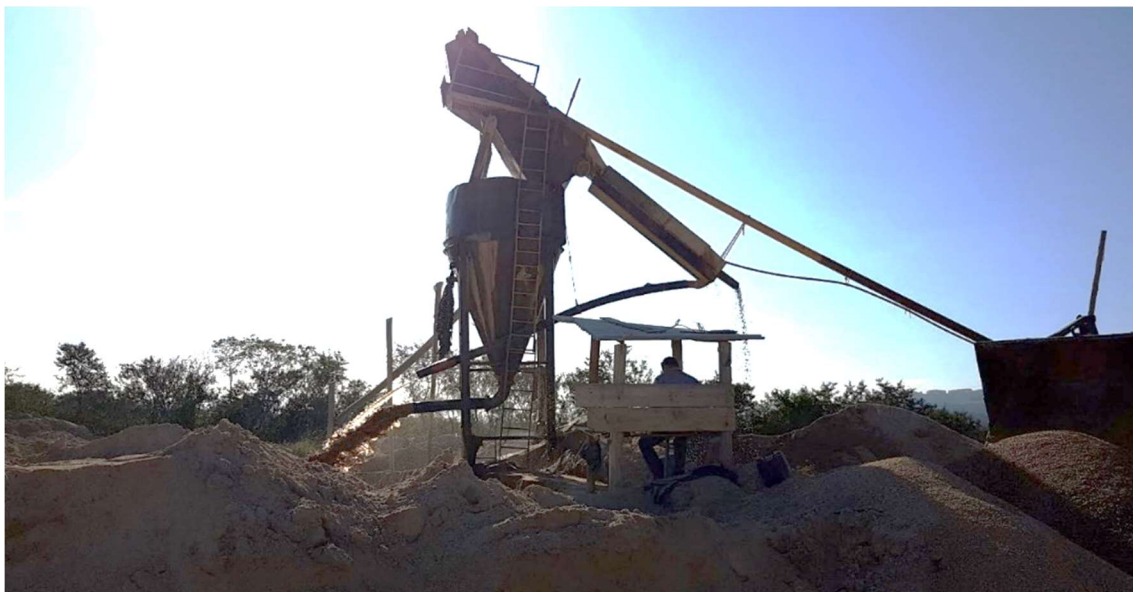
Figura 16 – Peneira fixa inclinada, utilizada para lavar e separar os grãos de feldspato.
