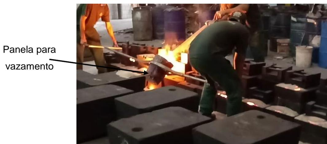
Figura 6 – Vazamento manual (do Autor, 2020)
