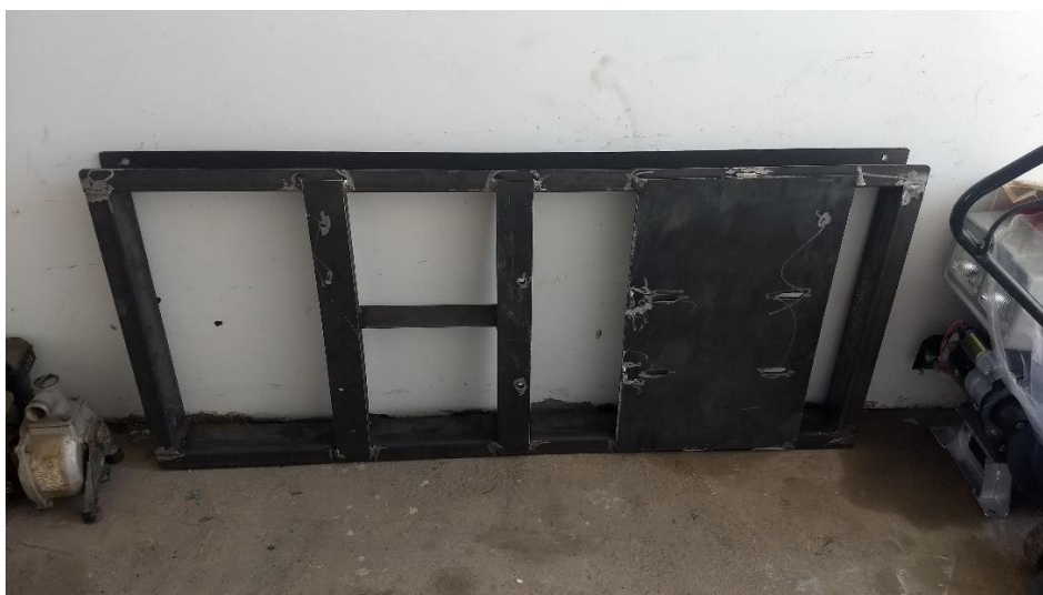
Figura 7 — Base estrutural Gerador de Energia (Do autor, 2020).
