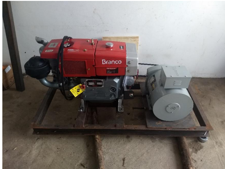
Figura 8 — Motor Branco monocilíndrico ciclo Diesel (Do autor, 2020).
