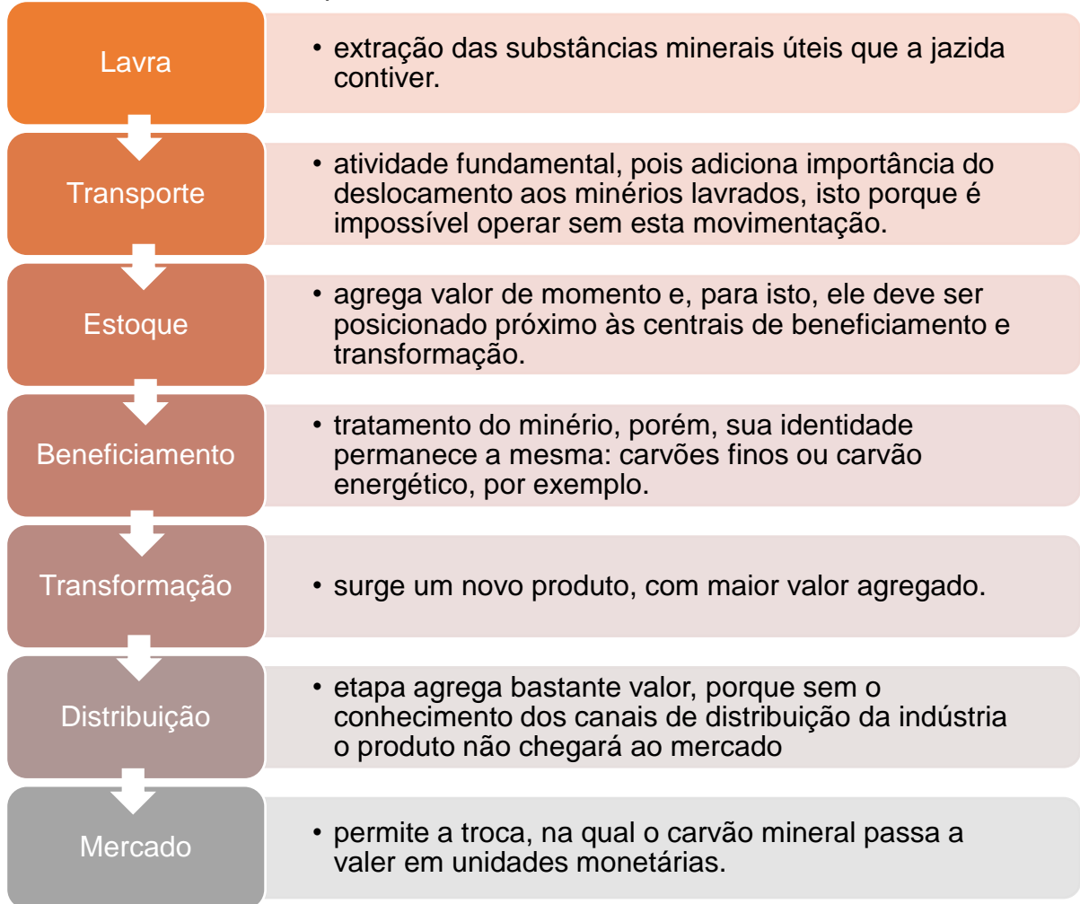
Figura 1: Fluxograma do processamento do carvão mineral.
