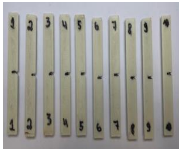
Figura 7: (a) Corpos de prova entalhados (b) Corpo de prova na máquina
