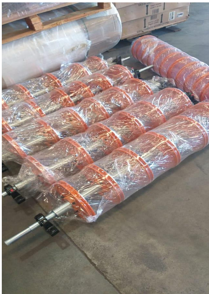
Figura 04 - Eixos montados para substituição
