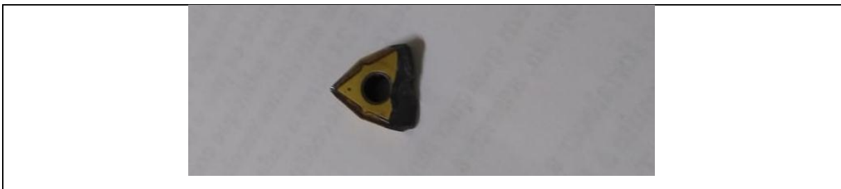
Figura 6 – Pastilha de corte desgastada (Do autor, 2020)
