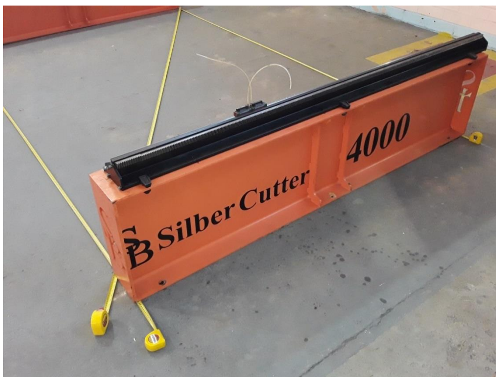
Figura 8 – Pré-alinhamento das bases do CNC (do autor, 2020)
