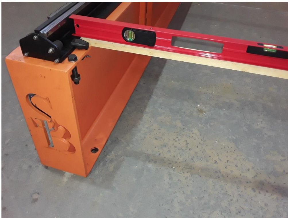
Figura 9 – Nivelamento da base com nível de bolha (do autor, 2020)
