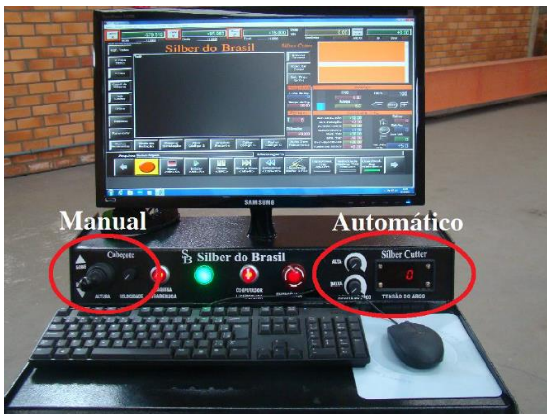
Figura 14 – Estação de operação manual e automática (Silber do Brasil, 2019)
