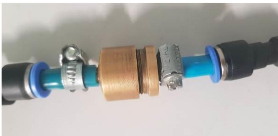
Figura 3 – Acoplamento para a válvula (Autor, 2019).
