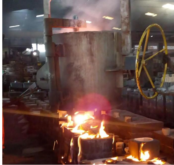
Figura 2 - Panela vazando metal líquido dentro do molde (do autor, 2020)
