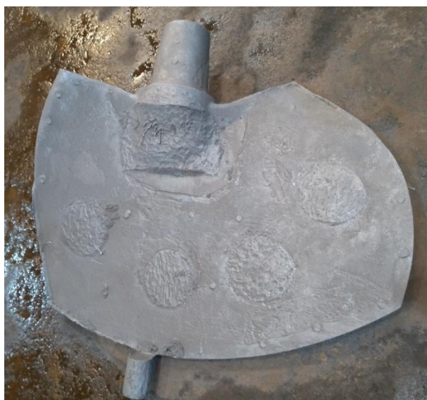
Figura 6 - Peça após corte de canais com pó de ferro (do autor, 2020)
