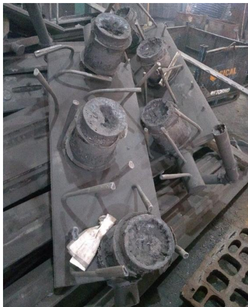
Figura 4 - Pá diretriz após desmoldagem com canais de alimentação (do autor, 2020)
