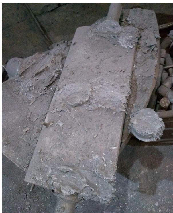
Figura 5 - Pá diretriz após corte dos canais com lança (do autor, 2020)
