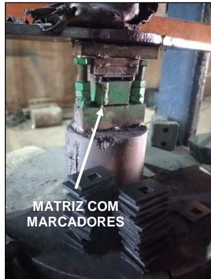
Figura 10 – Marcação de nome e data na chapa (Autor, 2020).
