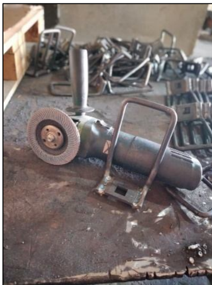
Figura 14 – Acabamento completo do estribo (Autor, 2020).
