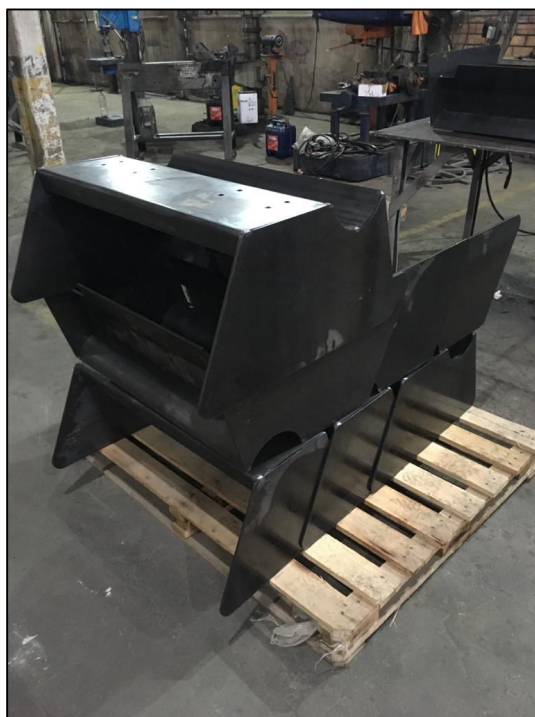
Figura 20 – Caçamba com suporte para rolete.
