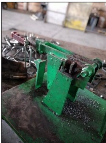
Figura 12 – Gabarito de montagem para pontos de solda (Autor, 2020).
