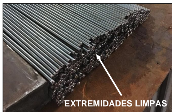
Figura 7 – Desbaste extremidade da haste (Autor, 2020).
