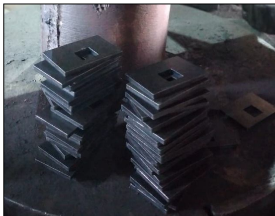
Figura 5 – Chapas cortadas a laser (Autor, 2020).
