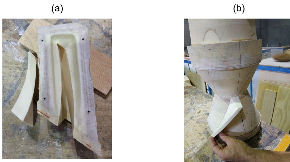
Figura 13 - (a) Molde de resina (b) Palheta Bipartida montada (Autor, 2020)
