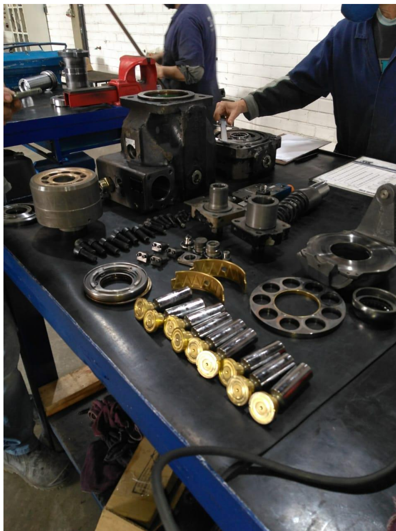
Figura 08: Bomba hidráulica de um cliente em perícia pelos técnicos (Fonte: do autor, 2020)
