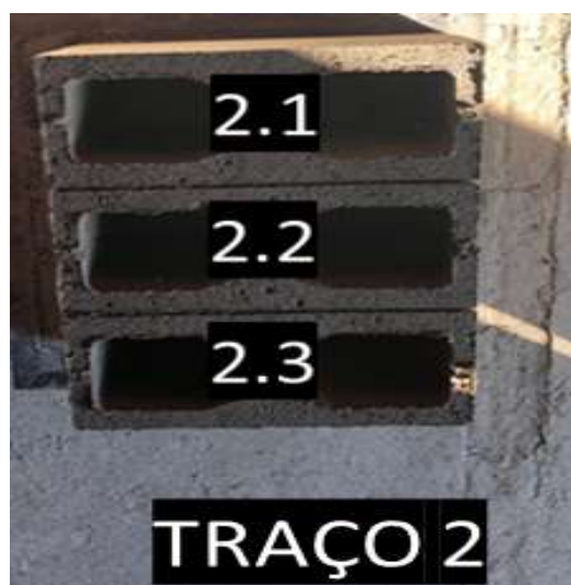
Figura 5: Identificação dos blocos de concreto para análise dimensional.
