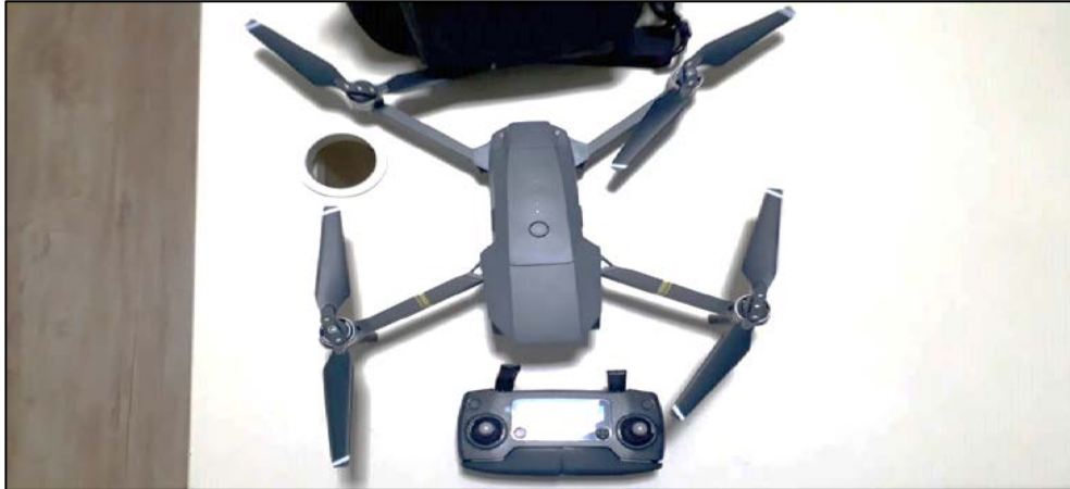
Figura 5: Aeronave utilizada para registros fotográficos do talude rodoviário.
