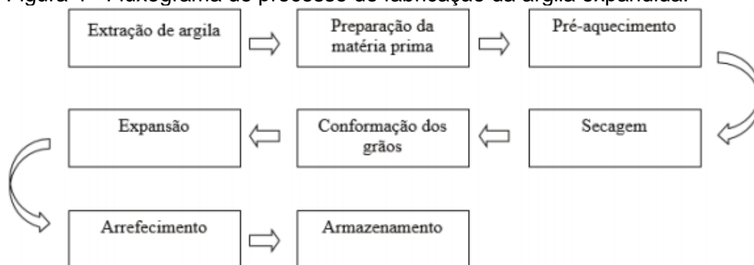
Figura 4 - Fluxograma do processo de fabricação da argila expandida.
