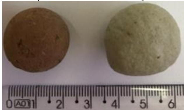
Figura 22– Estrutura externa da argila expandida: a esquerda a comercial e a direita a produzida com a formulação 5.
