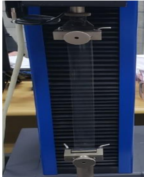
Figura 6: Corpo de prova posicionado para análise de módulo de elasticidade.
