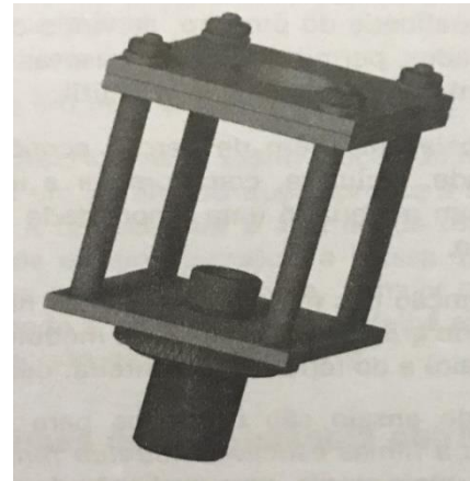
Figura 8: Estrutura de fixação da amostra.
