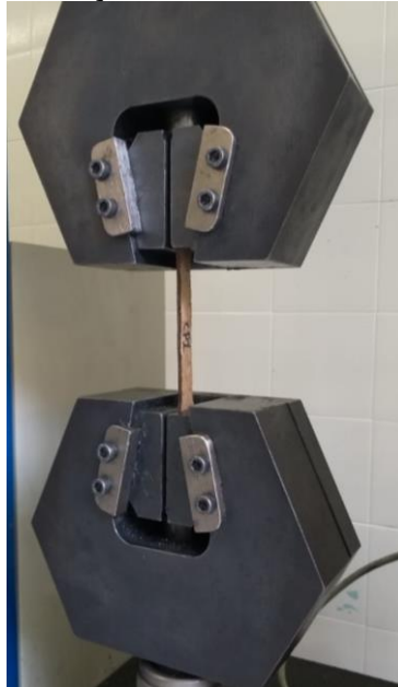
Figura 6 – Corpo de prova posicionado na máquina de tração.
