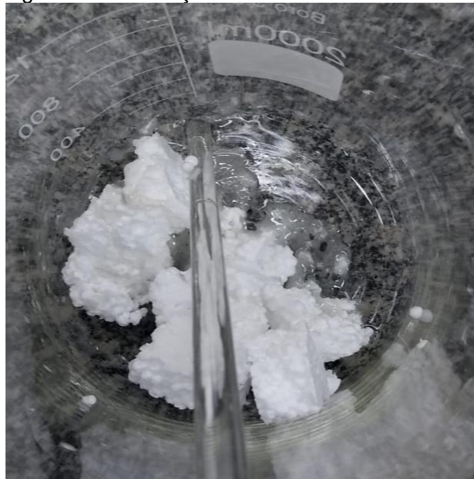
Figura 8 – Dissolução do EPS com o d-limoneno.
