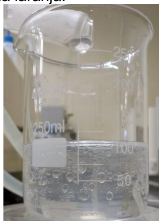
Figura 7 – Extrato de uma hidrodestilação da casca da laranja.
