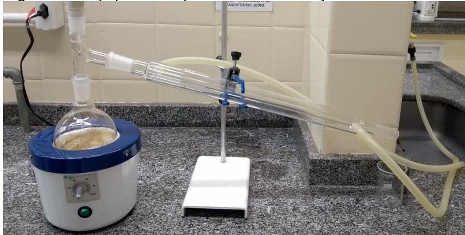
Figura 3 – Equipamento para a hidrodestilação em laboratório.
