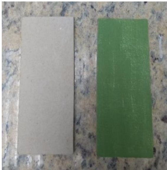
Figura 5: Placas de aplicação para intemperismo em equipamento BGD.
