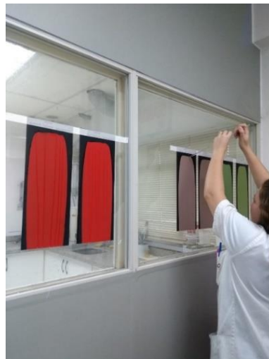
Figura 8: Escoamento da água no teste de manchamento.
