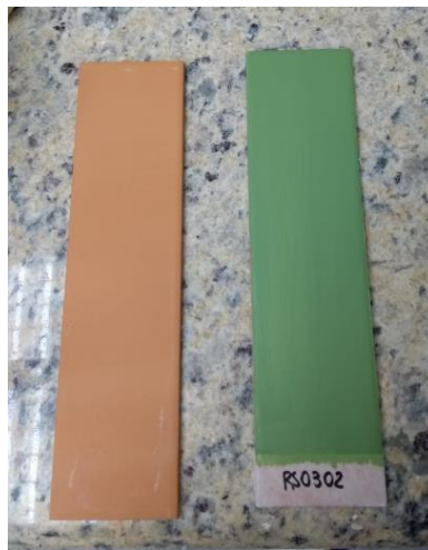
Figura 9: Aplicação do teste de eflorescência.
