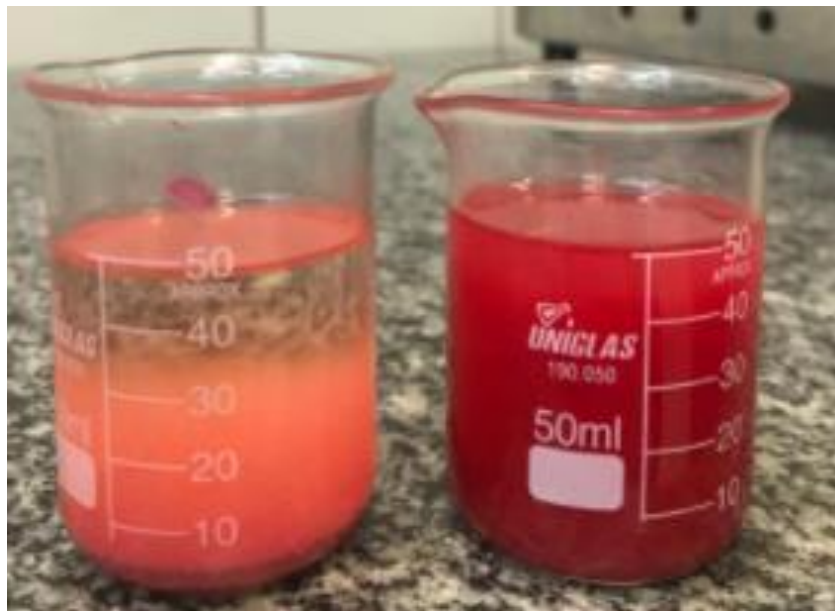
Figura 14: Sedimentação de pigmento.
