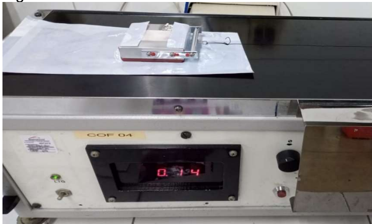
Figura 8: Teste de COF.
