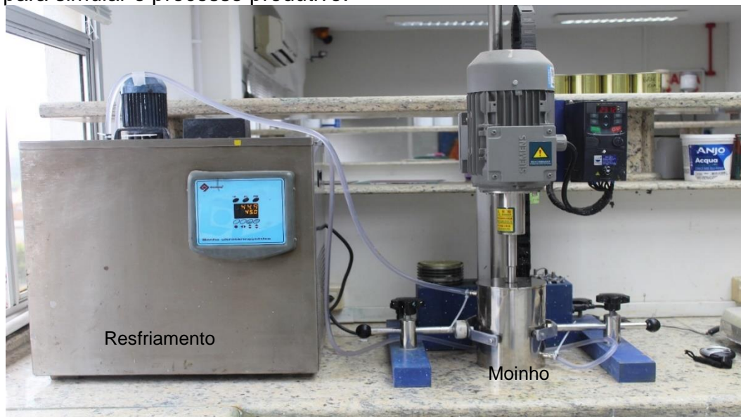
Figura 8 – Sistema de moagem e resfriamento montado em laboratório para simular o processo produtivo.
