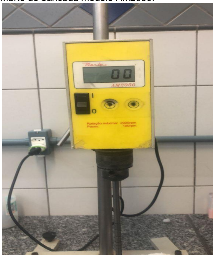
Figura 5: Mistura das matérias-primas no agitador Marte de bancada modelo AM2050.
