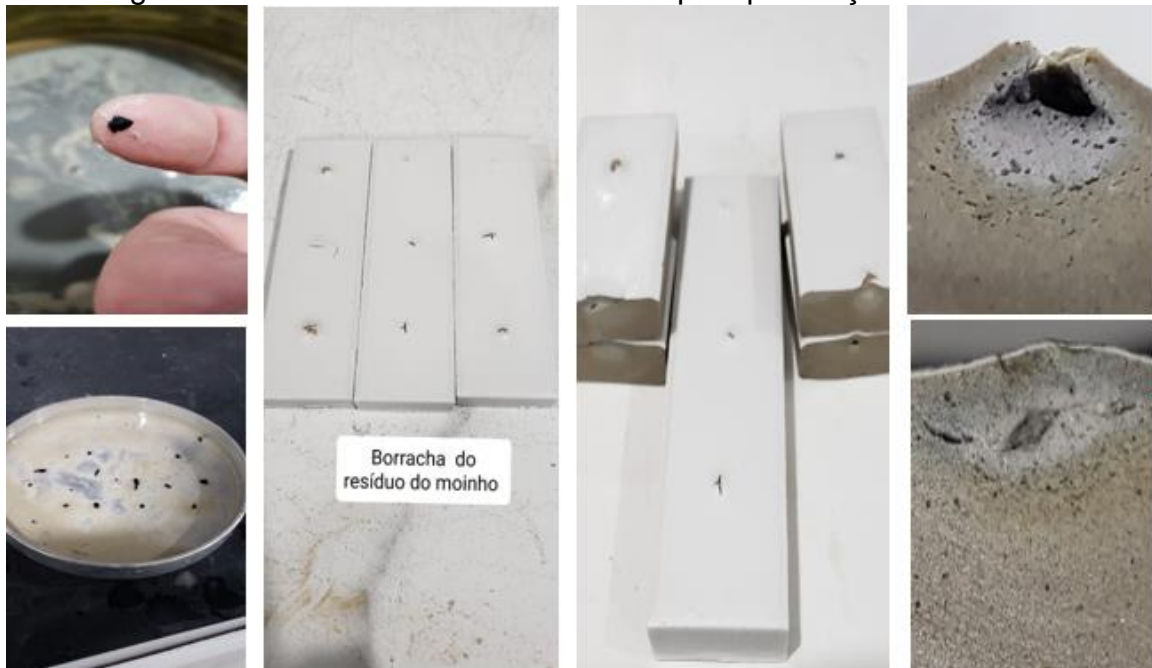
Figura 9: Defeito característico causado pela presença de borracha.
