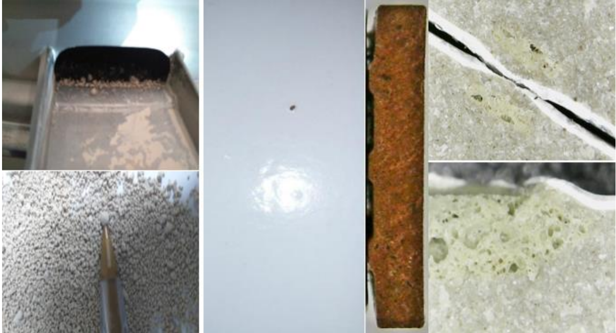
Figura 13: Defeito característico causado pela presença de grânulos grosseiros.
