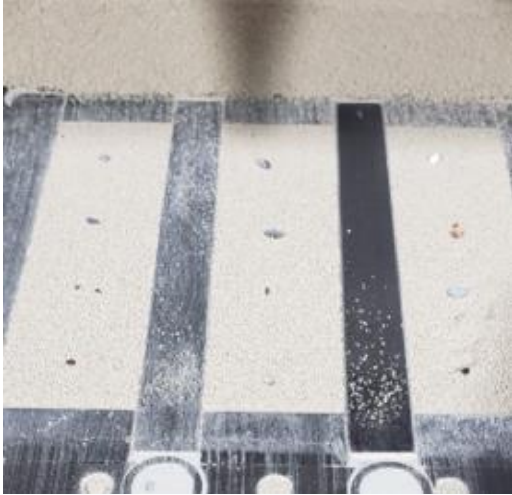
Figura 6: Massa atomizada na prensa com os materiais contaminantes.
