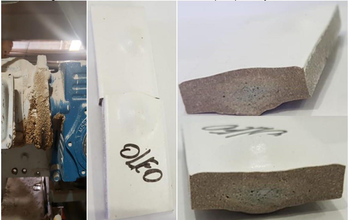
Figura 10: Defeito característico causado pela presença de óleo.
