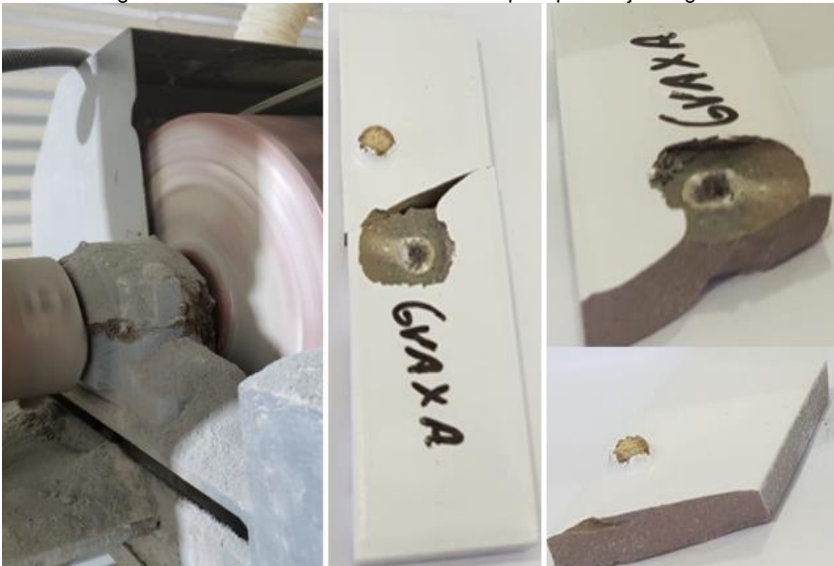
Figura 11: Defeito característico causado pela presença de graxa.
