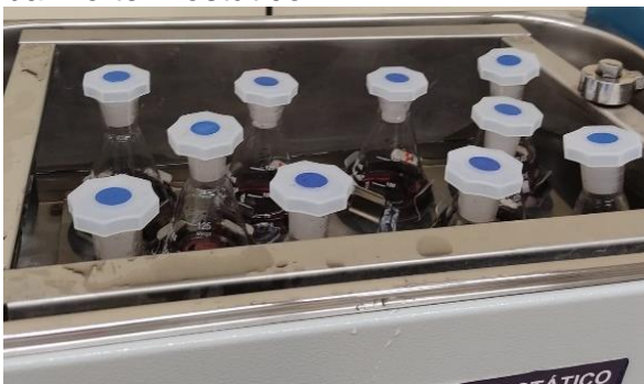
Figura 10: Soluções, com o BL, no banho termostático.
