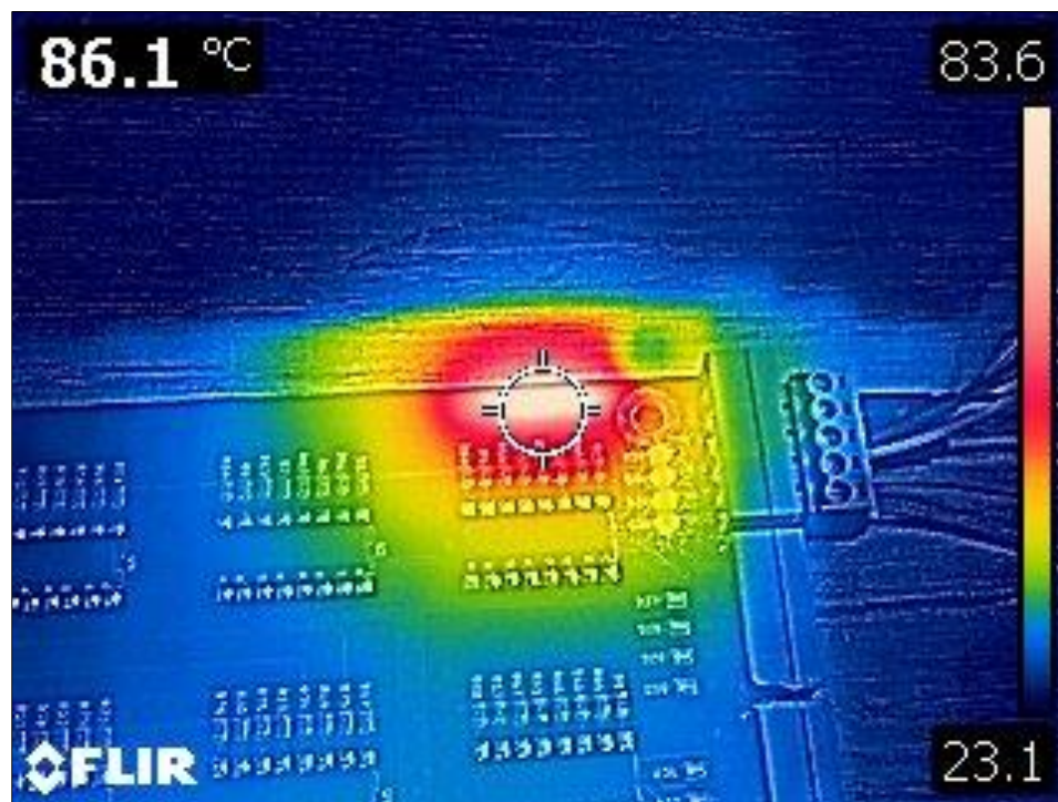
Figura 15: Imagem de câmera termográfica da placa principal
