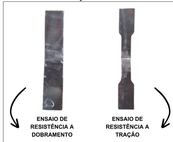
Figura 10: Corpos de prova ensaio dobramento e tração.
