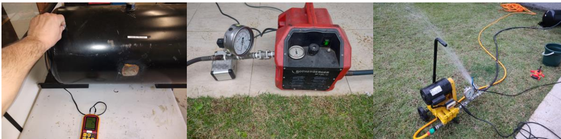
Figura 2: Vaso de pressão e equipamentos utilizados para ensaios não destrutíveis e destrutíveis.
