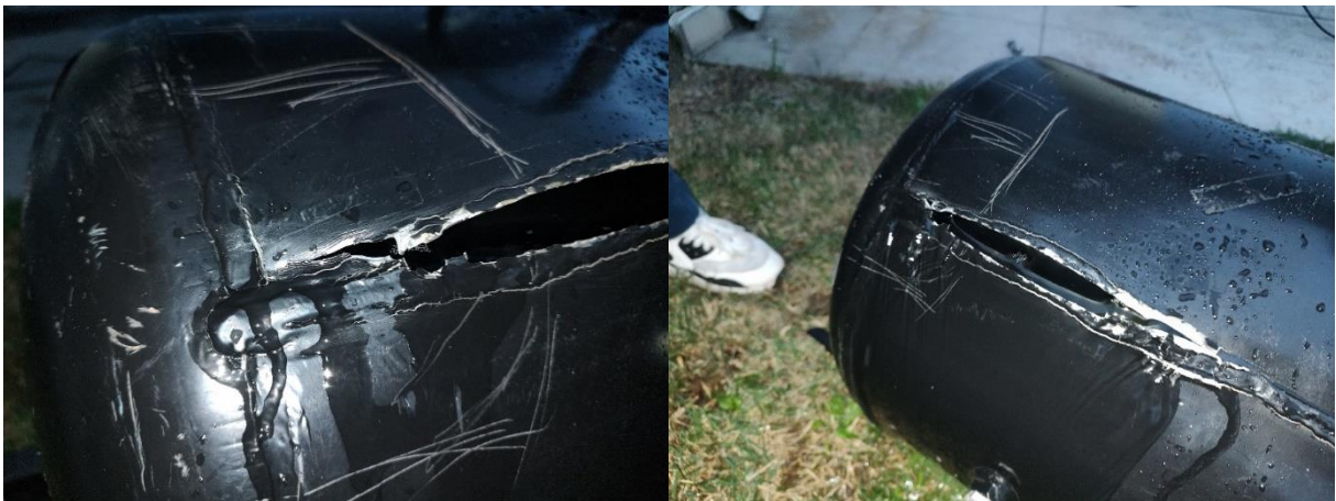
Figura 14: Local de ruptura do vaso.
