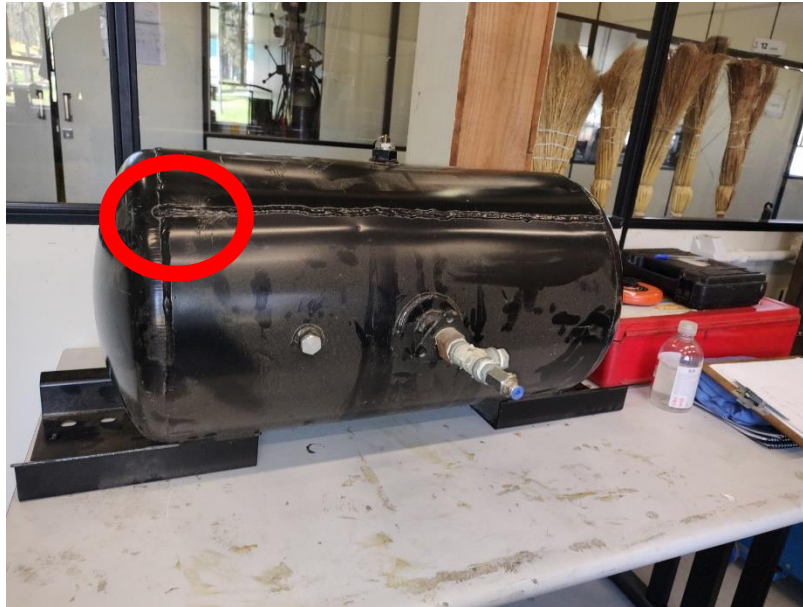
Figura 11: Local de indicação de falha de solda no vaso de pressão.
