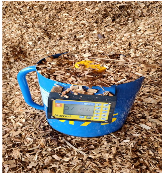
Figura 6 - Medição da umidade do cavaco através de equipamento.
