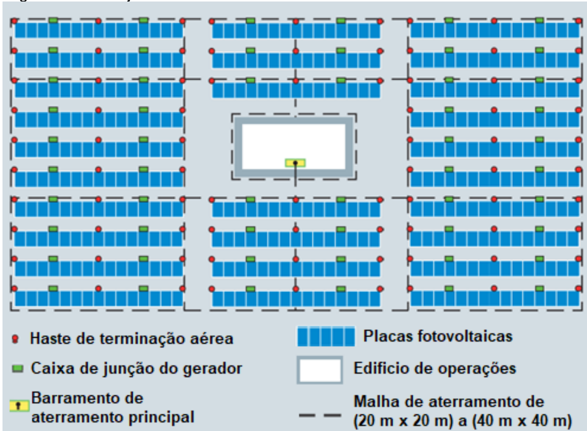
Figura 05 - Arranjo da malha de aterramento.
