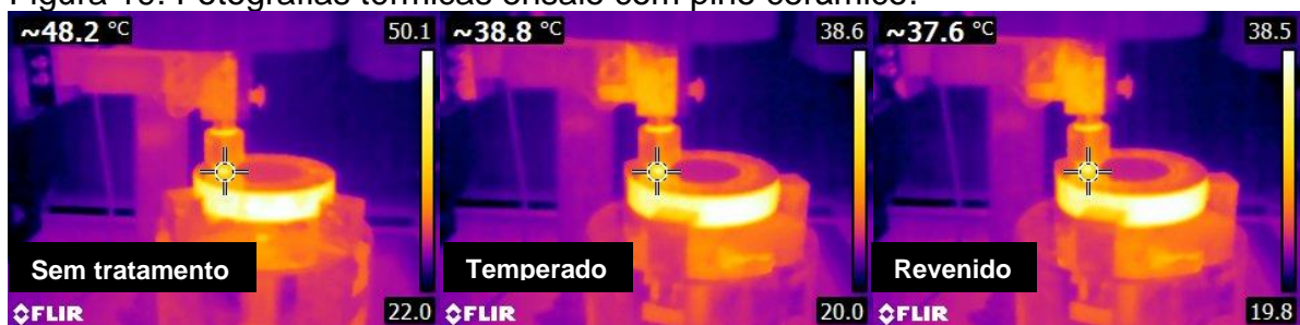
Figura 19: Fotografias térmicas ensaio com pino cerâmico.
