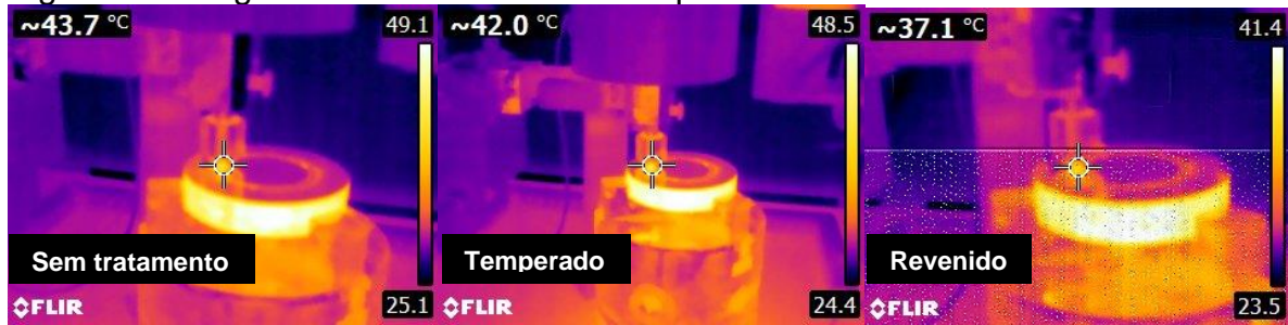
Figura 20: fotografias térmicas ensaio com pino metálico.
