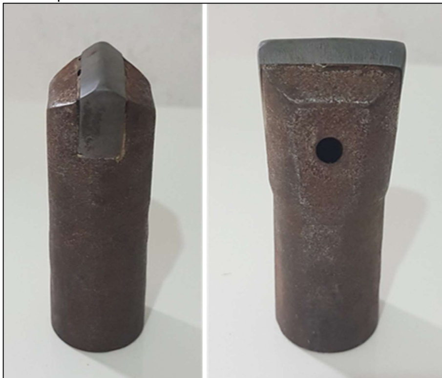
Figura 2: Broca perfuradora com inserto de tungstênio. a) vista frontal, b) vista superior
