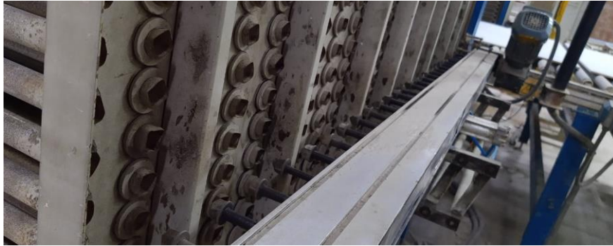
Figura 13: Mecanismo de retirada de biscoitos dos carros box
