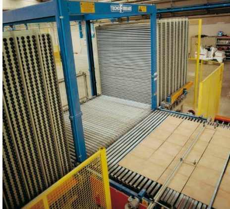
Figura 1: Elevador de carga
