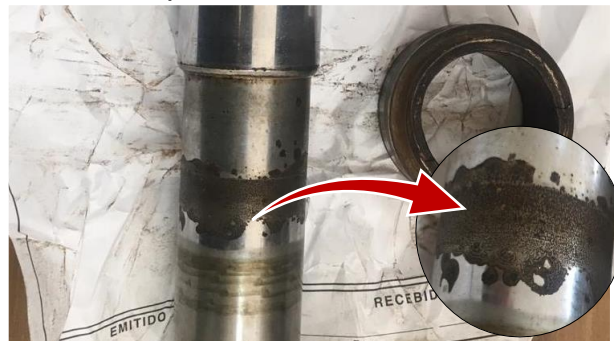
Figura 5: Degaste apresentado no eixo do martelo de potência.
