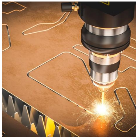
Figura 2: Corte a LASER em chapas metálicas.
