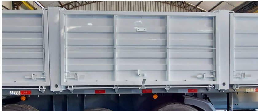
Figura 26: Protótipo da nova tampa metálica.
