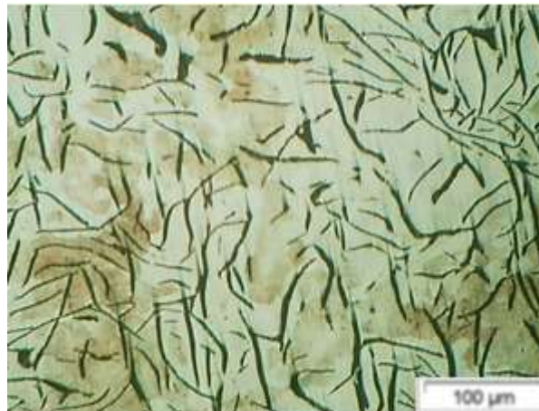
Figura 1: Micrografia ótica do ferro fundido cinzento.
