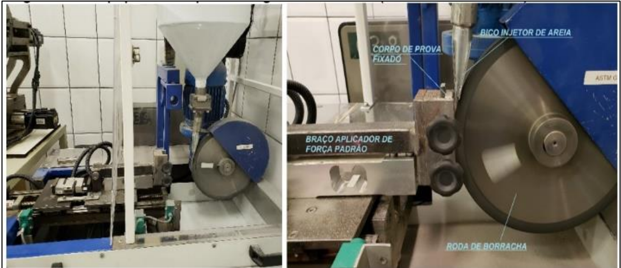
Figura 15: Máquina de ensaio de desgaste abrasivo.
